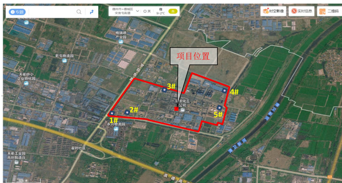
图 4.2-1 厂区地下水监控井布置图
